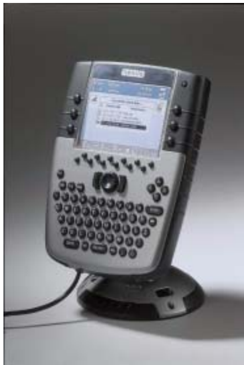
figuur 9 Voorbeeld van een multifunctionele boordcomputer met route- en fileinformatie, rijstijl feedback, etc.
