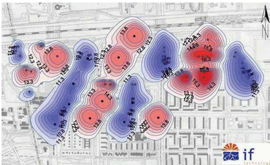
Figuur 8 Versterking van potentieel koude-/warmteopslag door gerichte positionering van bronnen; voorbeeld Zuid-As Amsterdam 2005
