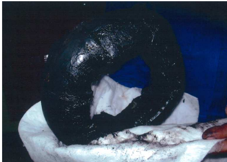
Figuur 5 Schade aan scheepsmotoren door afzetting van polystyreen. a) in de centrifuge, b) in het filtersysteem
