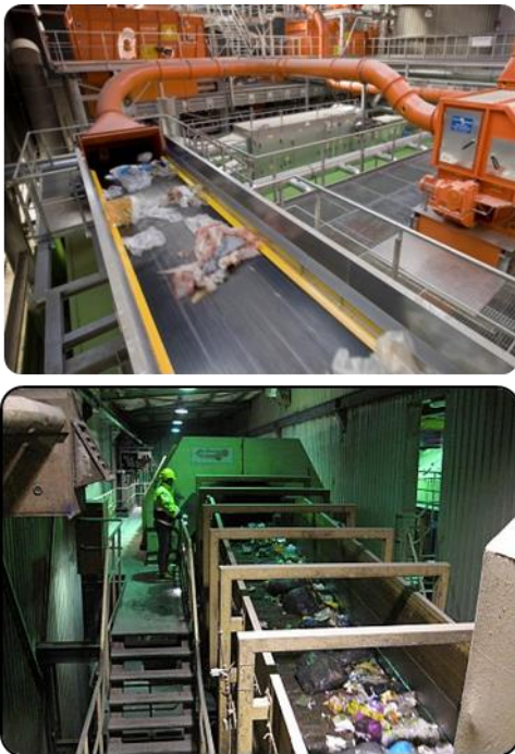
Figuur 6 Installaties voor bron- en nascheiding
