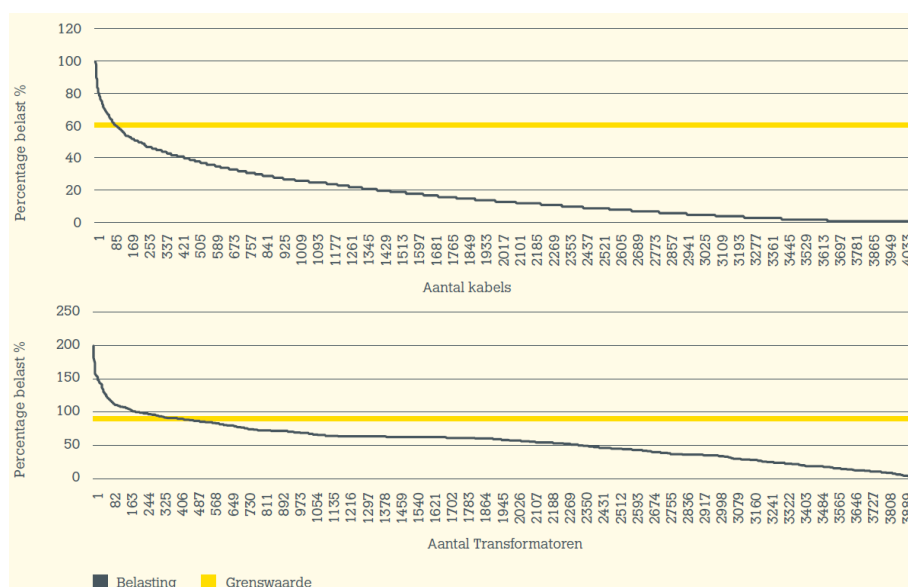
Figuur 27 Illustratie van het overzicht van belasting van 13kV MS-kabels (boven) en van MS- en LS-distributietransformatoren (onder) in een deel van het Stedin verzorgingsgebied
