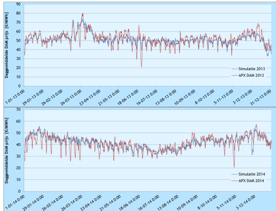
Figuur 9 Daggemiddelde elektriciteitsprijzen in de simulatie en APX DAM Nederland in €/MWh, voor 2013 (boven) en 2014 (onder)
