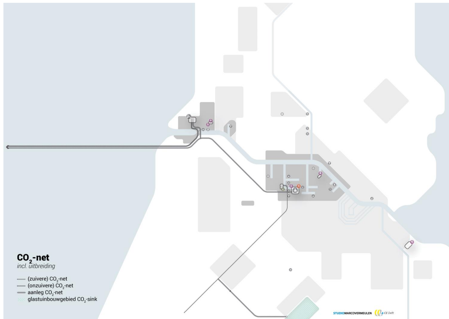
Figuur 11 - Mogelijke schematische ligging van het CO 2 -net in het NZKG
