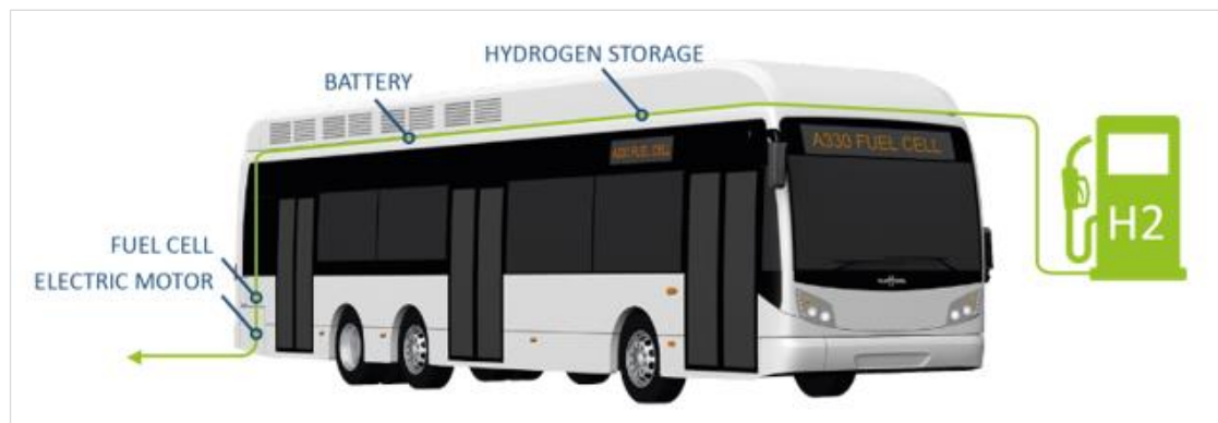
Figuur 7 - Waterstoftanks en de batterijen zitten in het dak van een brandstofcelbus ingebouwd
