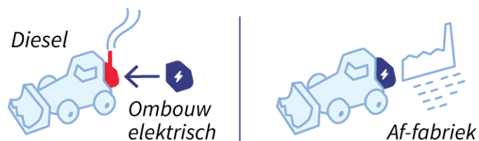
Figuur 2 - Twee typen batterij-elektrisch werktuig, ombouw van dieserversie naar batterij-elektrisch of werktuig ontworpen en gefabriceerd vanuit de fabrikant (af-fabriek)
