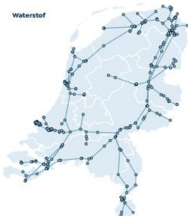
Figuur 1-2 - Configuratie transportnetwerk voor waterstof in 2050 (NetbeheerNL, 2021)
