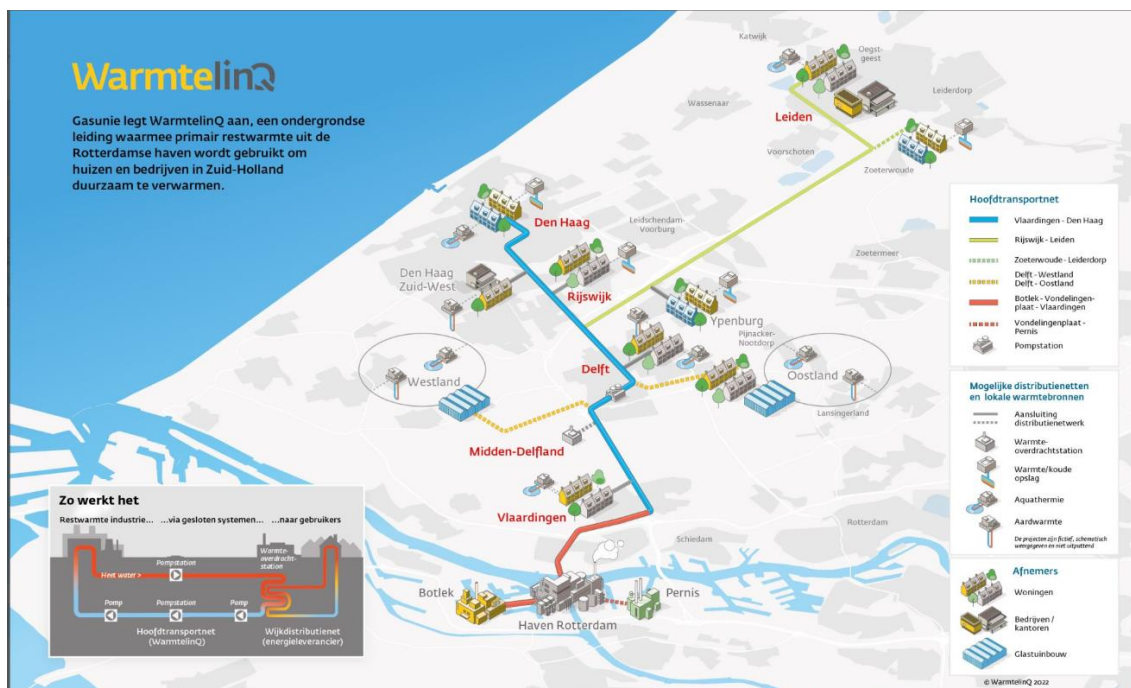
Figuur 5-2 - Overzicht van leidingen binnen WarmtelinQ
